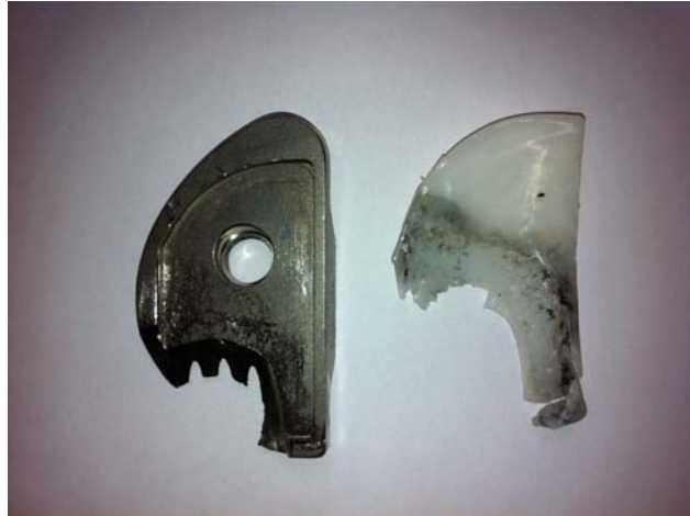
(fig. 2: particolare delle componenti protesiche rimosse che appaiono notevolmente usurate)
